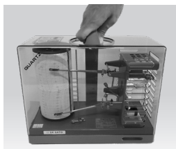
18.キャリングハンドルを正面にまっすぐ向け、アクリルカバーのSK SATOのプレートが前にくるように取り付ける。
