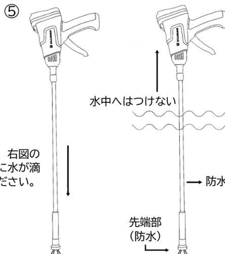
水中に投入した場合は、右図のように吊るして、本体に水が滴り落ちるのを防いでください。
