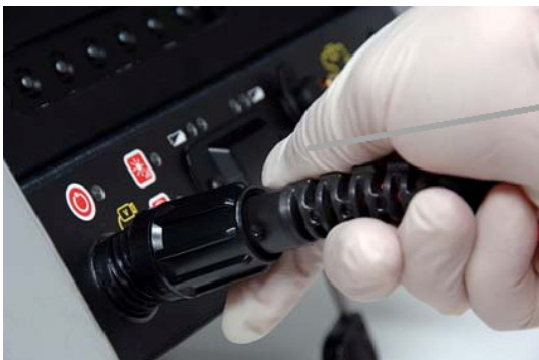
図 13 : シースネイクをモニターに接続する
