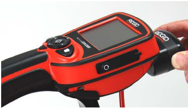
図 9 : マイクロエクスプローラーデジタル検査カメラを接続する
