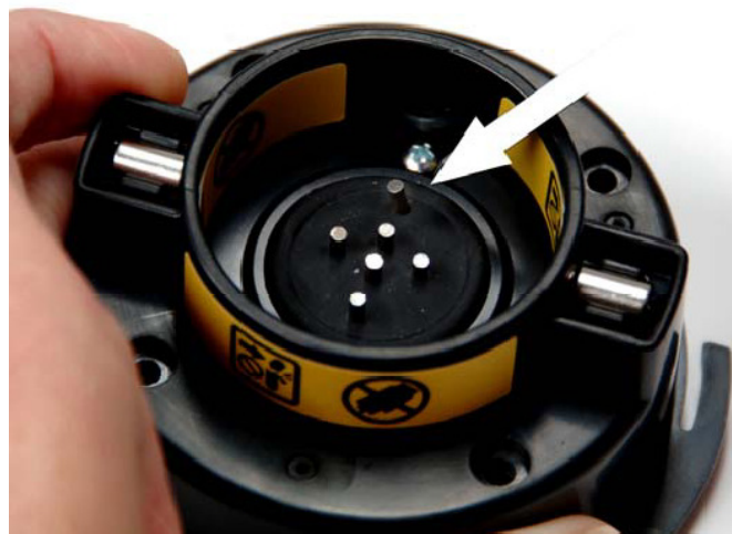
図6：壊れた接続ピン
