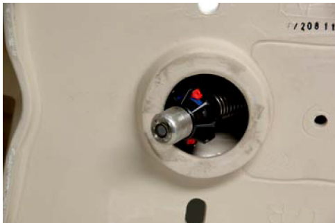
図 22：ボールガイドの付いたカメラヘッドが曲がり目の中にあります
