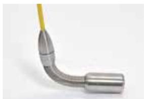
カメラ先端部はバネが入っており曲げる事の出来る最小半径は90度の直角配管で50mm幅があれば進めます
