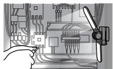
分電盤・電設盤にくっつけて配線作業時に手を照らします。
