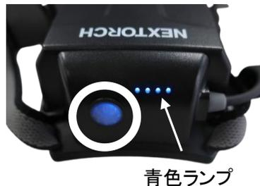
電池ボックスにあるパワースイッチを押すと、青色ランプが点灯し、電池残量を確認することができます。(図3)
