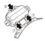
爪を①②の順ではめ込み、「バッテリーホ ルダーから取り外す方法」を参考に逆手順 で取り付けます。
