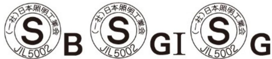
の表示がある照明器具は断熱材施工器具です。
