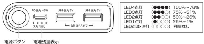
過電流や外部短絡などの異常発生により保護回路が動作すると、残量LEDが全て点滅して動作を停止させます。残量LEDが全て点滅して動作が停止する場合には、一度接続を解除しケーブルの断線や定格超過など異常がないか確認してください。
