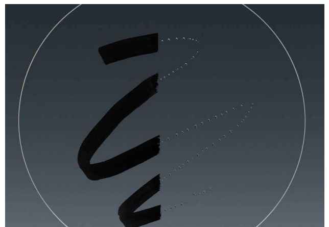
油性ペンによるコーティング有無の比較 左：防汚コートなし 右：防汚コートあり
