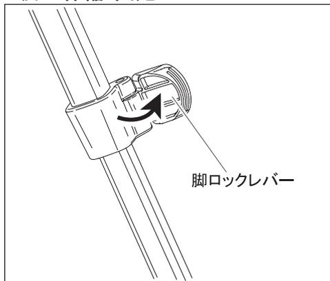
脚の伸縮は、脚ロックレバーを起こして脚を引出し必要な長さで脚ロックレバーを倒して固定します。脚を全段引き伸ばさないうで使用する場合は、できるだけ太い脚を使って撮影して下さい。
