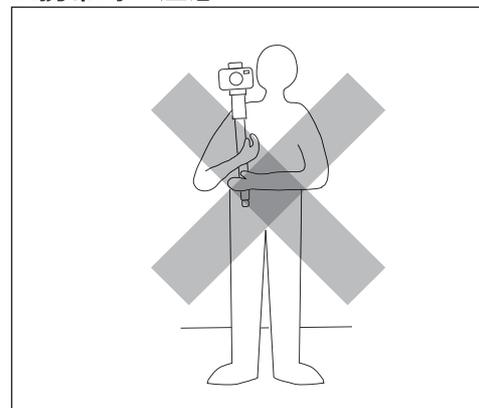
撮影場所の移動などの際は、必ず雲台からカメラを外して携帯してください。カメラを取り付けたまま携帯すると、予想以上の力が加わりカメラが落下・破損する恐れがあります。
