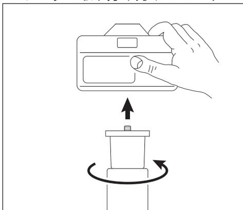
カメラ底面のネジ穴に一脚のカメラネジを合わせ、一脚全体を上図矢印方向に回して、しっかりと固定します。
