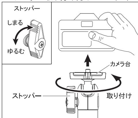
ストッパーをゆるめ、カメラ底面のネジ穴と雲台のカメラネジを合わせ、カメラ台を上図矢印方向へ回して固定します。
