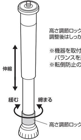
高さ調節ロックを緩めると一腳本体の高さを調整できます。調整後はしっかりと締め付けて固定してください。
