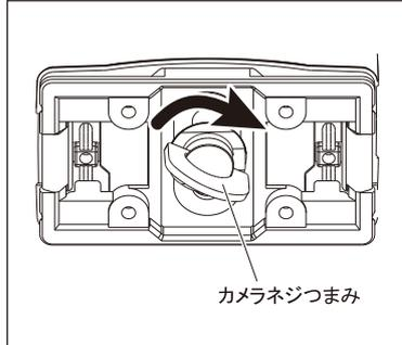
カメラ底面のネジ穴と、クイックシューのカメラネジを確実に合わせ、クイックシュー裏面のカメラネジつまみを起こして回し、しっかりと確実に取り付けして下さい。
