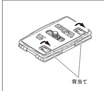
背当てをおこすと、カメラ縦位置時のレンズの重さによる前倒れを防ぐことが可能です。背当てはカメラネジの位置を移動させ、カメラ背面にうまく合わせて下さい。
