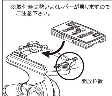
シュー固定レバーを開放位置にした状態でクイックシューをレバー側から斜めに滑らせるように取り付け、下に押し付けるとレバーが戻り半自動固定されます。後は手動で、レバーをしっかりと押し込んで下さい。
