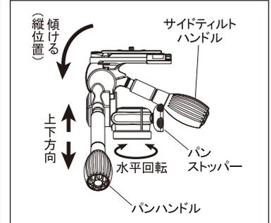
パンハンドルを反時計方向に回し緩めるとカメラの上下方向が変えられます。サイドテイルトハンドルを回し緩めると、カメラを縦位置にすることができます。パンストップパーを回し緩めると、カメラを水平回転することができます。構図が決まった位置で各ストップパーを締め、シャッターをきります。
