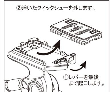
シュー固定レバーを最後まで起こすとクイックシューが浮き上がりますので、上図矢印方向へスライドさせながら本体から外します。
