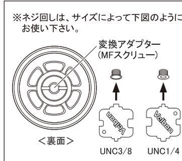
三脚取付ネジ穴は、ご購入時はUNC1/4インチ(細ネジ)用となっておりますが、同梱の変換アダプターによりUNC3/8インチ(太ネジ)の三脚に取付けることが可能です。付属のネジ回しやコイン等でアダプターを交換して下さい。
