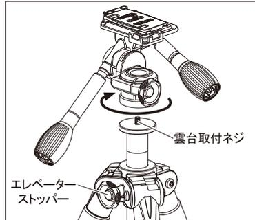
三脚への取り付けは、雲台のストップパー類及び三脚のエレベーターストップパーを確実に締めてからおこなって下さい。三脚の雲台取付ネジと雲台底面の取付ネジ穴を合わせ、雲台全体を時計方向にゆっくり回し、しっかりと固定します。
