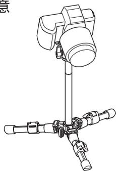
延長ポールを使用する際は脚をローポジションにセットして、一本の脚をレンズと同じ向きにご使用ください。搭載する機材によっては不安定な場合がありますので事前に確認をして、不安定な時には延長ポールでの撮影は中止してください。
