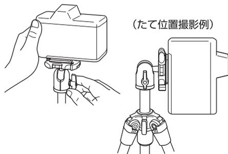
カメラをささえながらボールロックレバーをゆるめると、カメラ台はフリーになり、ベースプレートも回転します。アングルを決めてボールロックレバーをしっかりと締め付けてください。
