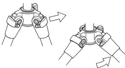
標準の開き位置から脚を少し閉じるようにして、開脚ストッパーを引き出すと残り二つの開脚角(ミドル、ローポジション)がえらべます。
