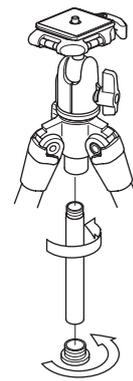
エレベーター下部へ延長ポールを矢印の方向へ回しながらねじ込んでください。延長ポール下部へエレベーター抜け止めを必ず取り付けてください。
