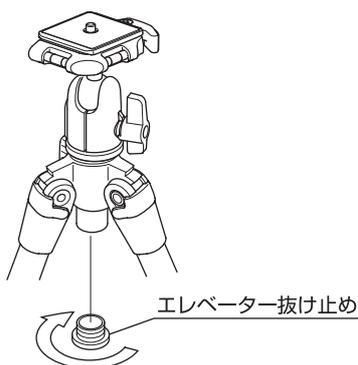
エレベーター抜け止めを矢印方向にねじり、エレベーターから取り外します。
