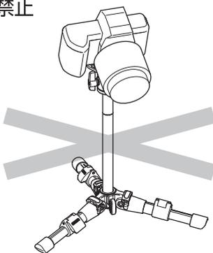
レンズの向きを脚と脚の間で使用するとカメラの自重で転倒する可能性がありますので、行わないでください。
