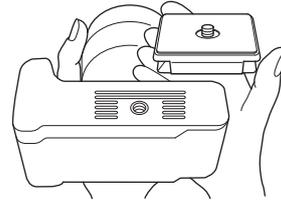
カメラの三脚取り付けネジとクイックシューのカメラネジを合わせて、カメラネジツマミを回し、しっかりと固定します。
