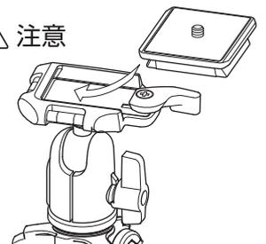
クイックシューをレバー側から斜めに滑らすように取り付けます。取り付けるとシュー固定レバーは自動的に閉じますが、さらにレバーを固定側に締め確実に固定します。
