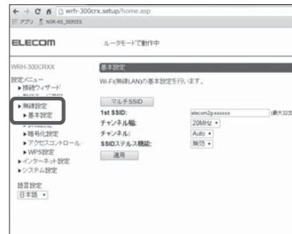
3 [チャンネル幅]にある▼マークをクリックし、40MHzへ変更して[適用]をクリックします。
