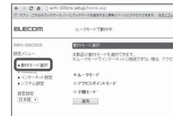
3 子機モードを選択し、[適用]ボタンをクリックしてください。本製品が再起動します。
