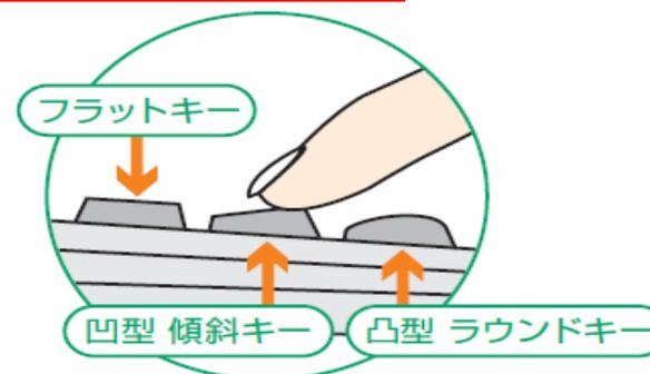
機能別に3つのキー成型を採用し、入力ミスを防ぎます。心地よいクリック感と、端の部分を押しても垂直にキー入力ができる安心構造を実現。更に素早いキー入力が可能な早打ち機能付。
