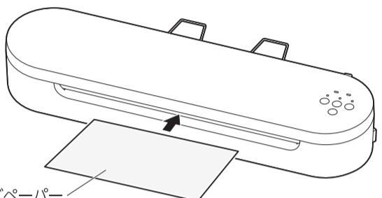
ローラーにラミネートフィルムの糊が付着しているとフィルムを巻き込むことがあります。また、古くなった糊は非常に取りにくくなりますので、ご使用の最後には、必ずローラーのクリーニングを行ってください。クリーニングには、付属のクリーニングペーパーをまっすぐフィルム挿入口に入れます。これを数回繰り返してください。
