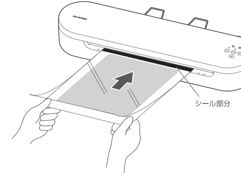
● フィルムサイズ表示に合わせ、シール部分を先頭にして、まっすぐに挿入します。
