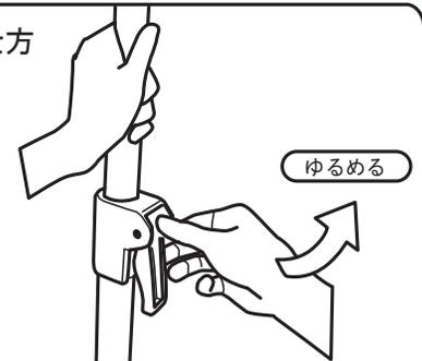
調整レバーを上げれば高さの変更が可能になります。その際、支柱上が下に落ちないように両手で作業を行ってください。
