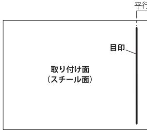
取り付け面と本品の間に空気が入らないように、貼り広げてください。その際、布などを持って、断面に触れないようにしてください。
