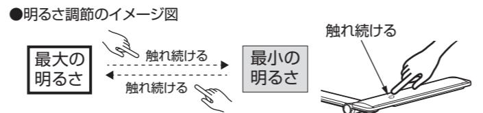
●調節された明るさは記憶されて、再点灯時にも同じ明るさで点灯します。
