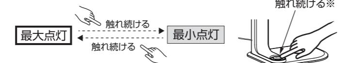
●調節された明るさは記憶されて、再点灯時にも同じ明るさで点灯します。
