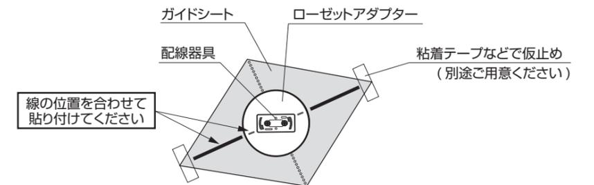
③ガイドシートの線位置にランプ本体の▲を合わせながら、引掛端子を配線器具に差し込み、時計方向(右)へ少しだけゆっくり回し、止まれば完了です。(SCL20シリーズのみ)
