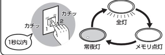
壁スイッチをONにしても点灯しないときは、壁スイッチを短く(1秒以内)操作して点灯状態を切り替えるか、壁スイッチをONにしてリモコンで点灯してください。
