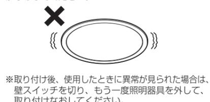
※取り付け後、使用したときに異常が見られた場合は、壁スイッチを切り、もう一度照明器具を外して、取り付けなおしてください。
