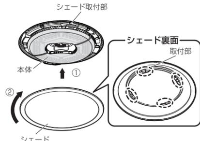
**注意** 本体を必要以上に回転させないでください。引掛シーリングやローゼットが破損します。
