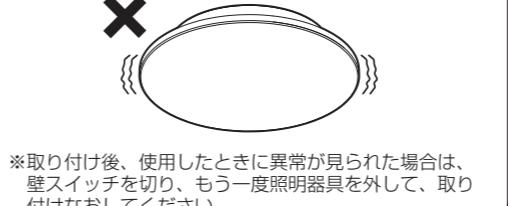
※取り付け後、使用したときに異常が見られた場合は、壁スイッチを切り、もう一度照明器具を外して、取り付けなおしてください。
