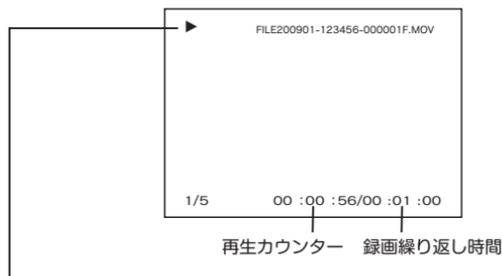
**記録 / 確定** ボタンを押すと再生を開始します。再生を一時停止するときは、**記録 / 確定** ボタンを押してください。（▶マークが▶||マークに変わります）
