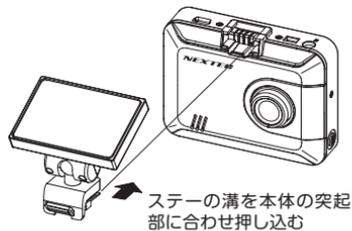
3. 車両の中央部から助手席側の運転の邪魔にならない場所をあらかじめ確認して、レンズを進行方向に向けてフロントガラスに貼り付ける
