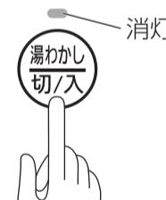
※湯わかしの停止後、再度お湯をわかすときは、加熱ボタンを使用してわかし、沸騰したら加熱を停止してください。
