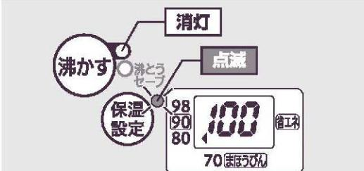
湯沸かしが完了すると湯沸かしランプが消灯、保温ランプが点滅
