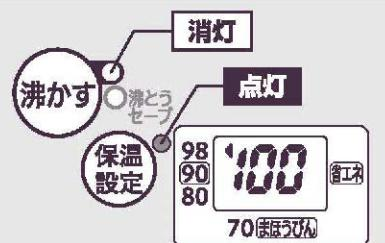
湯沸かしが完了すると湯沸かしランプが消灯、保温ランプが点灯
