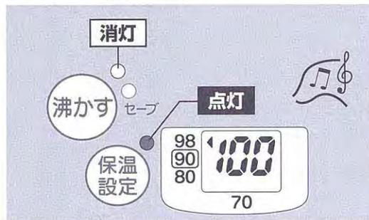
湯沸かしが完了するとメロディーが鳴り、湯沸かしランプが消灯、保温ランプが点灯
