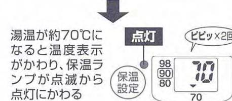
湯温が約70℃になると温度表示が変わり、保温ランプが点滅から点灯にかわる
