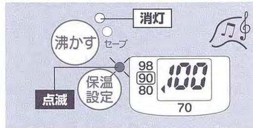
湯沸かしが完了するとメロディーが鳴り、湯沸かしランプが消灯、保温ランプが点滅(保温中に設定した場合、80保温設定の2秒後に点滅にかわります。)
