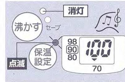
湯沸かしが完了するとメロディーが鳴り、湯沸かしランプが消灯、保温ランプが点滅(保温中に設定した場合、70保温設定の2秒後に点滅にかわります。)
