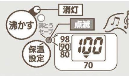
湯沸かしが完了するとメロディーが鳴り、湯沸かしランプが消灯、保温ランプが点滅
