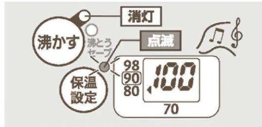
湯沸かしが完了するとメロディーが鳴り、湯沸かしランプが消灯、保温ランプが点滅
