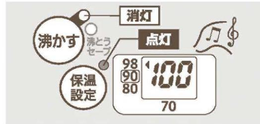
湯沸かしが完了するとメロディーが鳴り、湯沸かしランプが消灯、保温ランプが点灯
