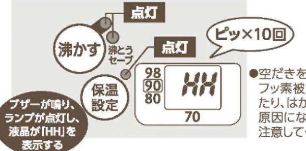
ブザーが鳴り、ランプが点灯し、液晶が「HH」を表示する
