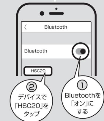
3 LEDランプが「7秒ごとに2回点滅」でペアリング完了です。次回からは本製品の電源をオンにした後、自動的に接続されます。
