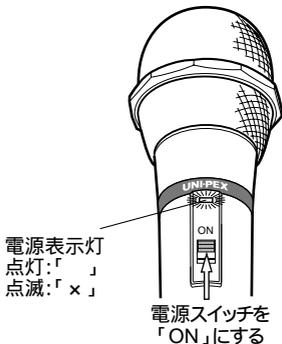
電源スイッチを入れ、電源表示灯が点灯すれば設定したグループ / チャンネルは正常です。電源表示灯が早く点滅する場合は、周波数設定が正しくできていないこと(5ページの受信周波数表にないグループ、チャンネルに設定している)を表しています。電源スイッチを切り再度周波数設定をしてください。
