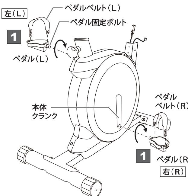
**△注意** 左(L)ペダルは、逆にネジを切っています。取り付けの際は付属の工具で左に回して取り付けしてください。右(R)ペダルは、右に回して取り付けしてください。
