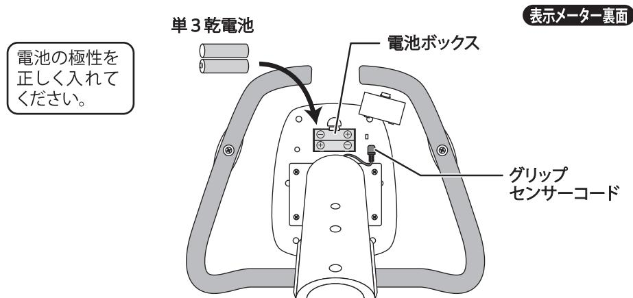
\*組立完了後、「ペダル負荷が変わらない」、「メーターが作動しない」場合は、組立手順4、5、8、10のコードの接続をご確認ください。
