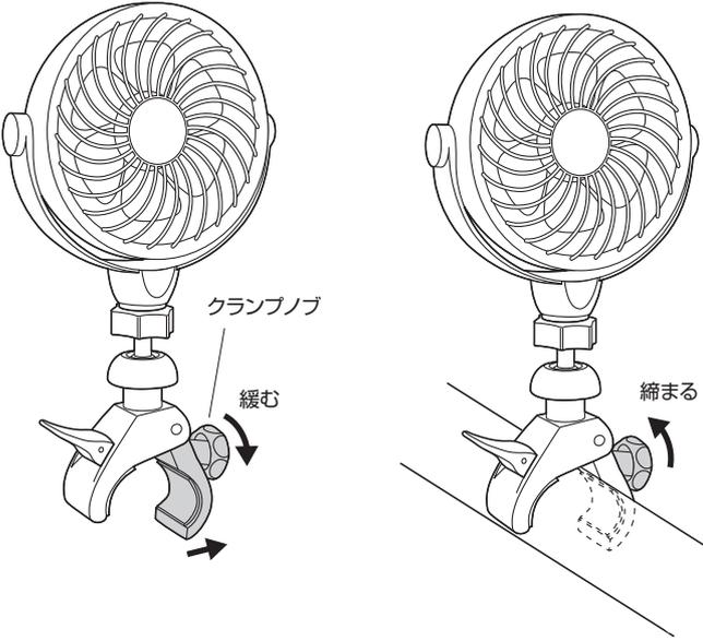
(3) 最後にクランプロックを下げて固定します。
