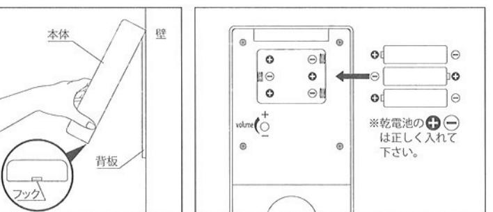
※流水音が小さくなったり、音質が劣化してたり、あるいは異音がし始めたら電池の寿命です。電池を3本取替えてください。
