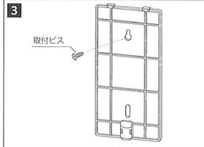
③位置を合わせる為、付属のねじ1本を上部穴にドライバーで仮締めしてください。
