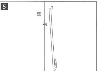
⑤仮止めのビスに合せ、背板を壁に貼り付けます。その後、仮締めしてあるビスを強く締め付けます。
