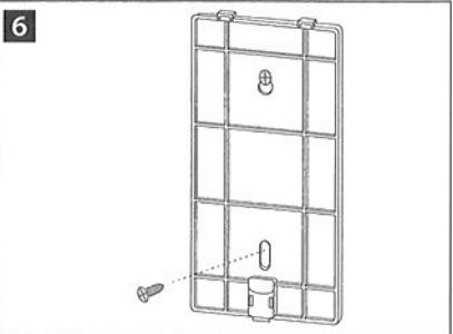
⑥付属のねじ1本を下部穴にドライバーで締め付けてください。
