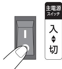
※カッターの回転が止まってから細断しない状態が約5分間続くと、電源・スタートランプが消灯し、自動的に電源オフになります。(オートオフ機能)
