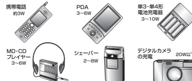
AC100V機器のプラグを本品のACコンセントに差し込み、シガーライターソケットに入れるだけでAC100V機器をご使用になれます。最大20Wまで。
