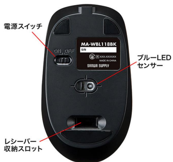
赤色の光学式より感度の高いブルーLEDセンサーを搭載
