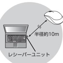
本製品の動作範囲は、レシーバーユニットとマウス本体が半径10m以内です。使用環境によっては、約10mの範囲内でもマウスが正常に動作しない場合があります。その場合は、動作が安定するところまで、マウスをレシーバーユニットに近づけてください。
