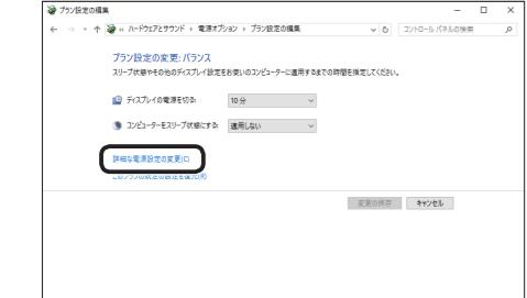
4. 「電源オプション」画面で、一覧から「USB 設定」の「+」マークをクリックし、「USB のセレクティブ サスペンドの設定」の「+」マークをクリックします。
