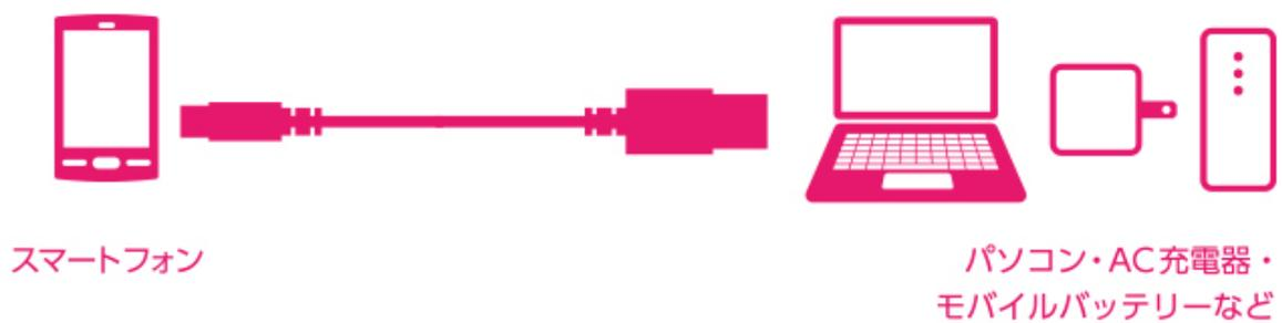
USB(Aタイプ:メス)のインターフェースを持つAC充電器やモバイルバッテリー、パソコンに、USB(MicroBタイプ:メス)のインターフェースを持つスマートフォンなどの機器を接続し、充電やデータ通信ができるmicroUSBケーブルです。
