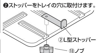
※L字ストッパーは左右に1個ずつ、V字ストッパーは上部に1個、下部に2個取付けます。
