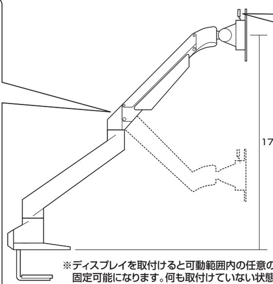
※ディスプレイを取付けると可動範囲内の任意の位置で固定可能になります。何も取付けていない状態の場合アームは常に最上位に戻ろうとします。
