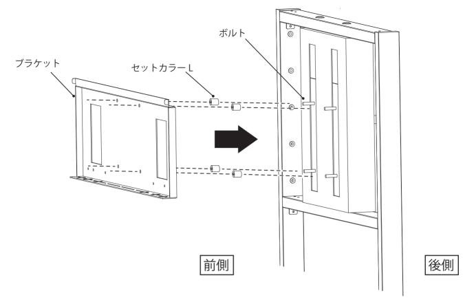
② 下図のように平座金 I、ばね座金 H、六角ナット G でブラケットを固定します。
