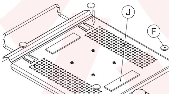
ノートPCを台にのせた時にノートPCがずれないようにするためのゴム製シールを上図のように貼り付けます。
