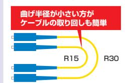
曲げ半径が小さい方がケーブルの取り回しも簡単
