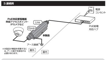
・PoE給電に使用するケーブルは、原則カテゴリ5eストレートケーブル、AWG24以上の仕様で ケーブル径5~12mmのものを選んでください。
