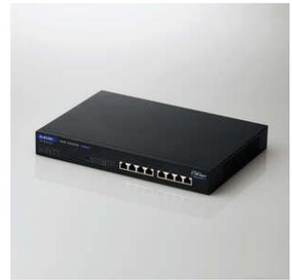
ギガ超の帯域を提供する2.5Gbps※1に対応。マルチギガビット対応で既存配線※2でも大幅な帯域向上実現。Webブラウザ経由でVLAN・QoSなどを設定できる2.5GBASE-T対応のレイヤー2 Webスマートマルチギガスイッチ。耐熱50℃、3年保証にも対応。更にオプションの延長保守で長期運用に安心の法人向けスイッチングハブ。 ※1理論上の最大値であり、実際の転送速度を示すものではありません。また2.5Gbpsで通信するには、接続するLANケーブルと機器がともに2.5GBASE-Tに対応している必要があります。 ※2既存配線とはCat5e/6を示します。
