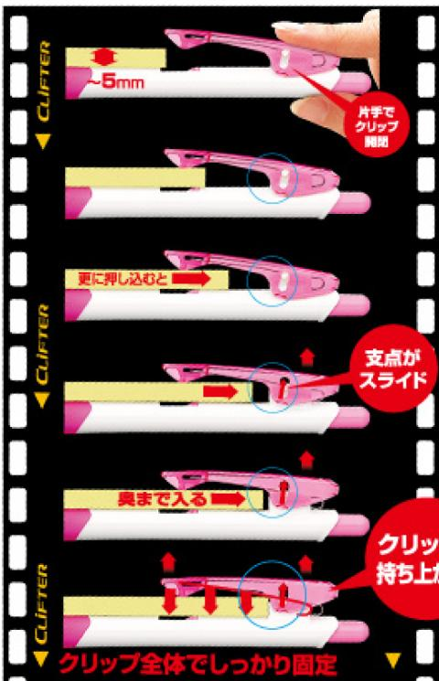
挟むものの厚みによって、クリップの支点部分がスライドすることで、挟んだものがクリップの奥まで入りクリップ全体で固定するため、安定した保持力を得ることができます。(もちろん薄いものでもしっかりと挟むことができます)。厚さ5mmのものをクリップ奥まで挟むことができます。
