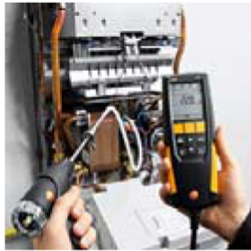
付属のシリコンホースを 使って差圧計測も可能
